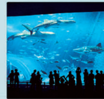
超巨大アクリルパネル水槽 透明度を落とさず何枚ものパネルを貼り合わせる重合接着技術と現場で行うジョイント重合接着技術が超巨大水槽パネル(アクアウォール TM )を生み出します。
